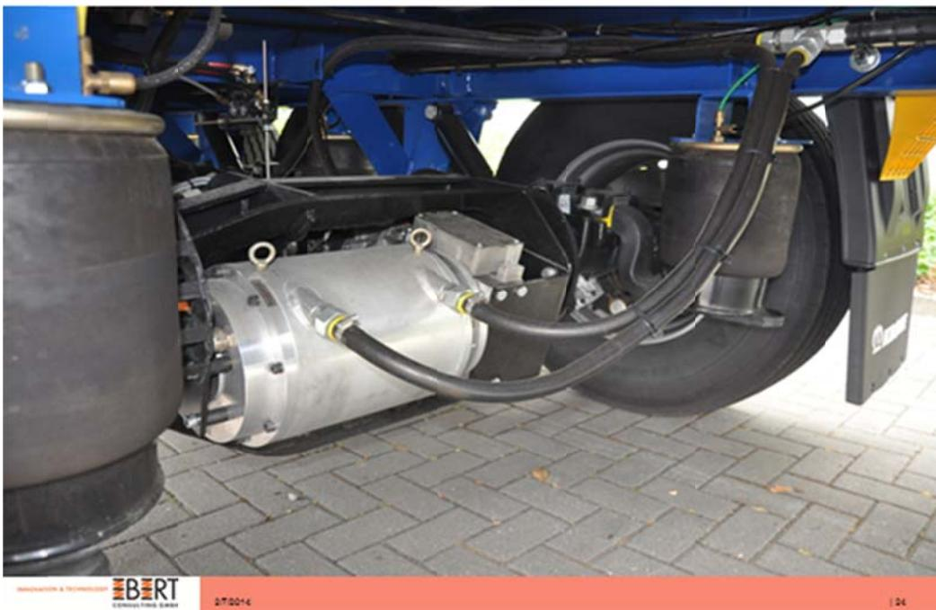
**Abb.7:** Studie Firma KRONE Fahrzeugtechnik – zwei Achsen mit wassergekühltem Generator und Differential und 40 kWh Batteriekapazität erlauben rein rekuperativen Betrieb der Kältemaschine | 1 |
